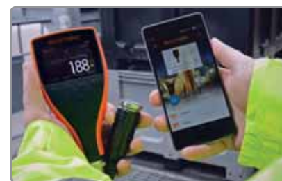
Sortie de données USB et Bluetooth® vers appareils iPhone ou Android™
