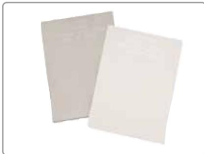
Elcometer fournit une gamme de plaques de vérification à valeur zéro. Ces plaques de vérification, lorsqu'elles sont utilisées avec un jeu de feuilles d'étalonnage, sont idéales pour mesurer avec précision les performances de votre jauge d'épaisseur, ou bien lorsqu'il est difficile d'obtenir une lecture sur une surface sans revêtement.
