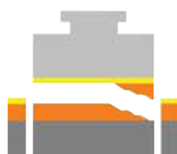
Fallo parcial de revestimiento
