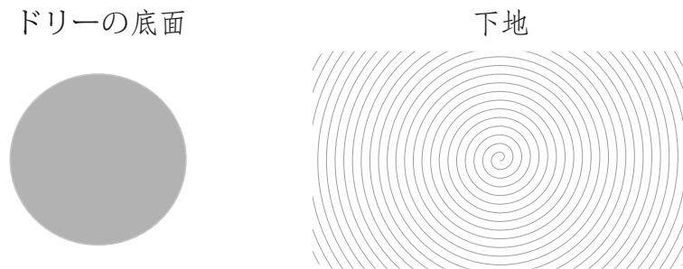
c) 接着剤層剥離
